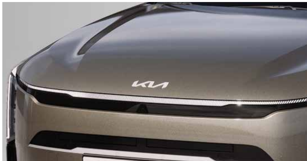
Жүру кезіндегі шамдардың жарықдиодты контурлы сызығы
