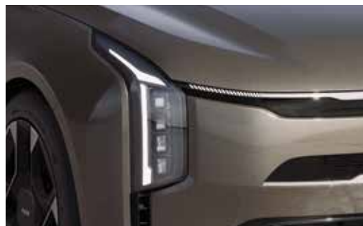
Матрицалық жарық элементтер жүйесі бар жарықдиодты алдыңғы фаралар
