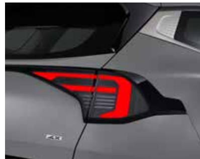
Задний комбинированный светодиодный фонарь (светодиодный сигнал поворота)
