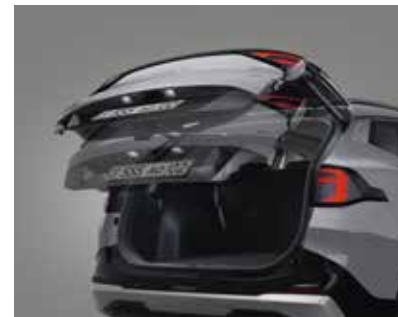
Электропривод багажника с дистанционным управлением (Smart Power Tailgate)
