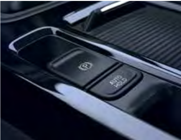
Электрический стояночный тормоз с функцией автоматического удержания (Auto Hold). Теперь не нужно беспокоиться, достаточно ли вы затянули рычаг парковочного тормоза — он легко включается одной кнопкой. А функция Auto Hold автоматически удержит автомобиль от скатывания до момента начала движения.
