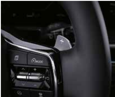
Рульдің астындағы берілістерді ауыстырып-қосу «жапырақшалары»
