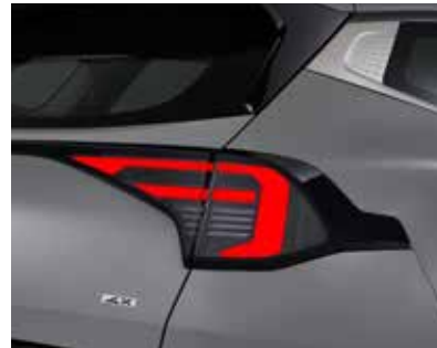
Артқы аралас жарықдиодты шам (жарықдиодты бұрылыс сигналы)
