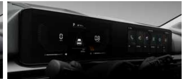
Аспаптар комбинациясы (түрлі түсті, 4,2 дюймдік TFT LCD дисплей)
