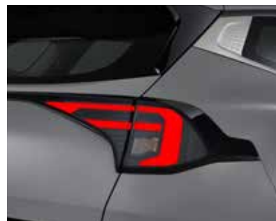
Артқы аралас жарықдиодты шам (қыздыру шамы бар бұрылыс сигналы)
