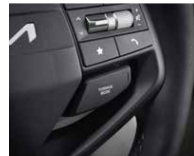
Terrain Mode Select жол жағдайларына (қар, батпақ, құм режимдері) бейімделу жүйесі
