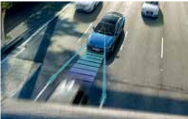
Интеллектуальный круиз-контроль (SCC) с функцией Stop&Go
