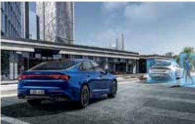
Система предотвращения фронтального столкновения (FCA)
