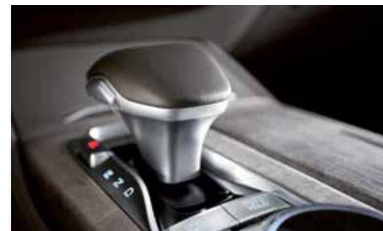
Электронное управление трансмиссией (Shift by Wire)
